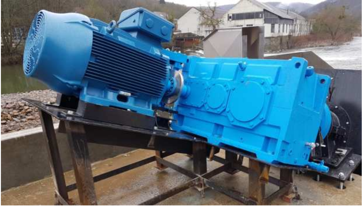
Figure 19 : Multiplicateur et génératrice (100 kW) – Méry, Belgique
