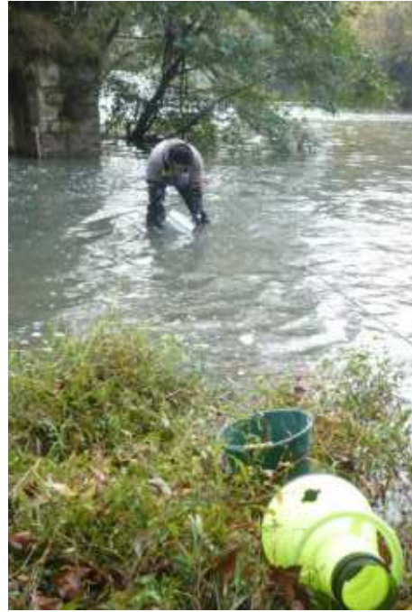
Figure 6 : Mise en œuvre du protocole Wolman sur une zone a l'aval du moulin (échantillons à gauche et transect à droite).
