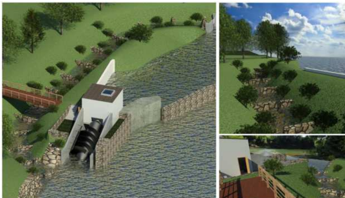
Figure 16 : Exemples de rivière de contournement pour le projet d'Ilharre en rive droite.
