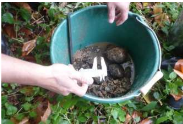
Figure 6 : Mise en œuvre du protocole Wolman sur une zone a l'aval du moulin (échantillons à gauche et transect à droite).
